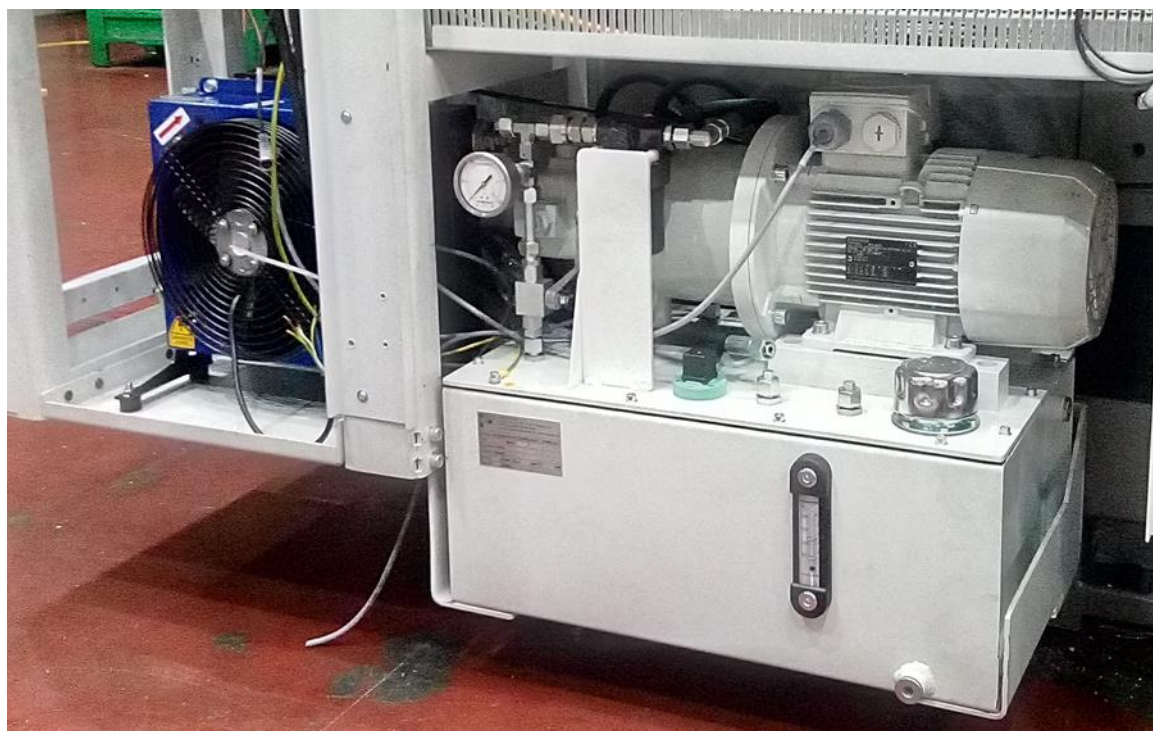
Hydraulická nádrž s chladením
