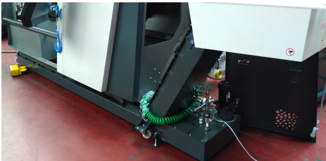
Nádrž chladiaceho zariadenia
