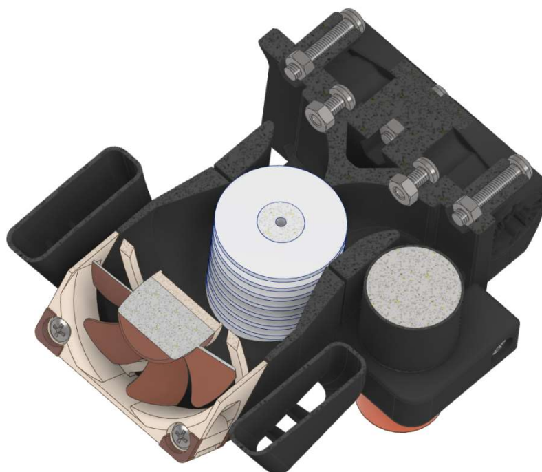
Horizontálny rez tlačovej hlavy
