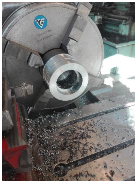
Obr. č. 14 Hotový domček pre ložiská [foto: Tokarčík M., 2018]
