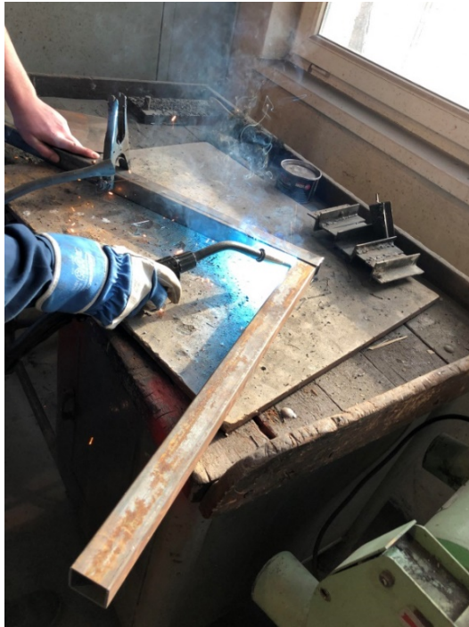
Obr. č. 4 Kútové zváranie [foto: Čopian, A., 2018]
