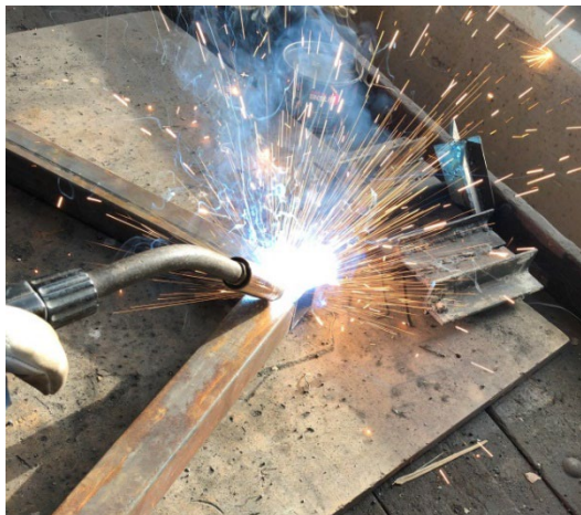
Obr. č. 5 Tupý zvar [foto: Čopian, A., 2018]
