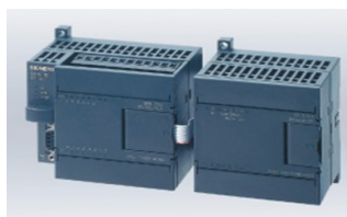
Obrázok 12 PLC Simatic S7-200 s modulom EM 223 ( foto Zeman P., 2018)
