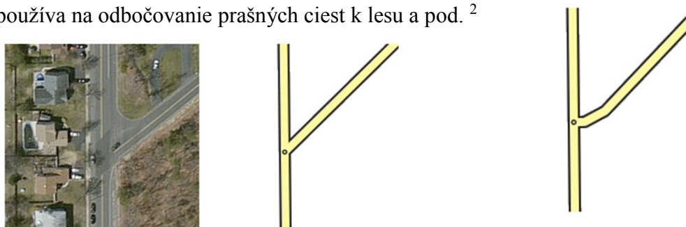
Obrázok 2 Skutočný tvar križovatky s ostrým uhlom a pridaním geometrického bodu vytvorí kolmé napojenie ciest, a stredovým segmentom,
