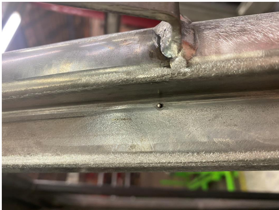
Obr. 9 Chyba pri zváraní
