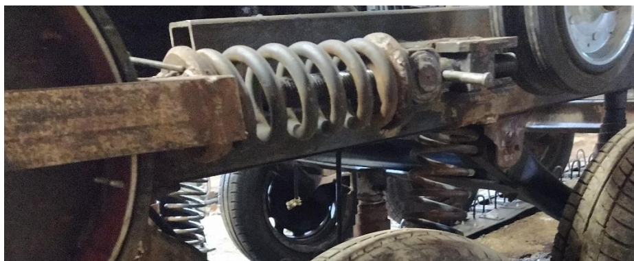
Obr.18 Skrutka napínania pásov
