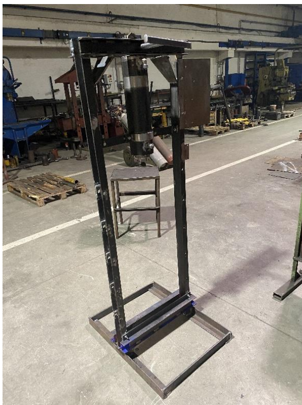
Konštrukcia hydraulického lisu ( Zdroj, Pohlod, D., 2023)
