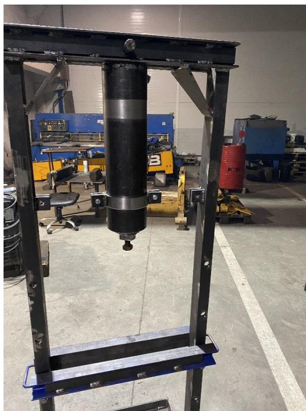
Uchytenie hydraulického valca ( Zdroj, Pohlod, D., 2023)
