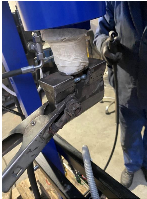
Obrázok 9 Upevnenie skrutky na štiepací nadstavec ( Zdroj, Pohlod, D., 2023)
