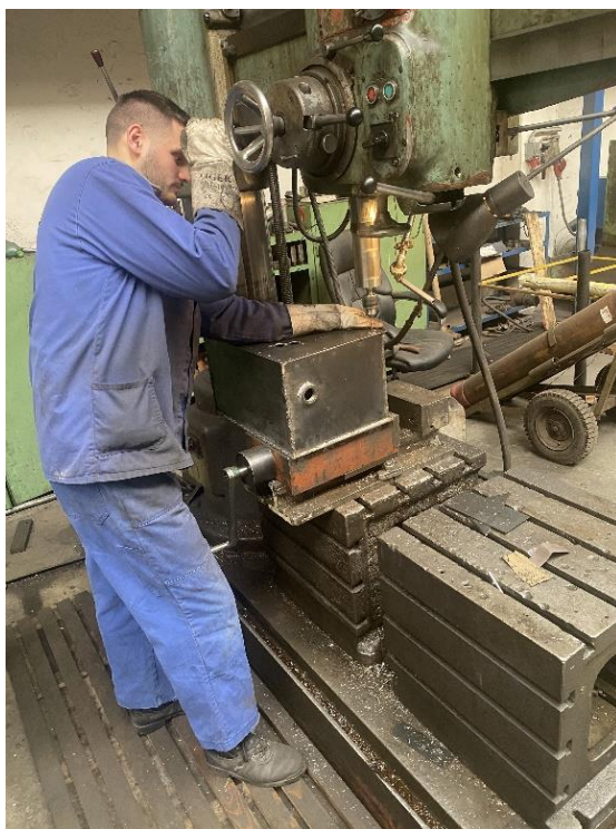
Vrtanie dier na uchytenie nádrže ( Zdroj, Pohlod, D., 2023)
