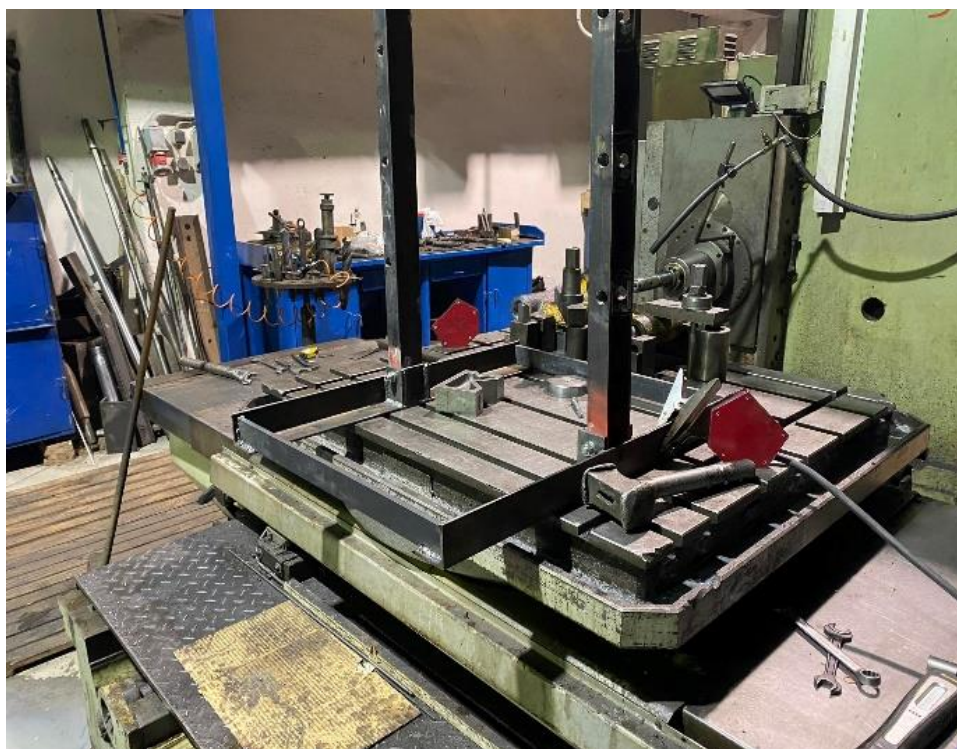
Obrázok 4 Uloženie podstavy na vodorovnú plochu ( Zdroj, Pohlod, D., 2023)
