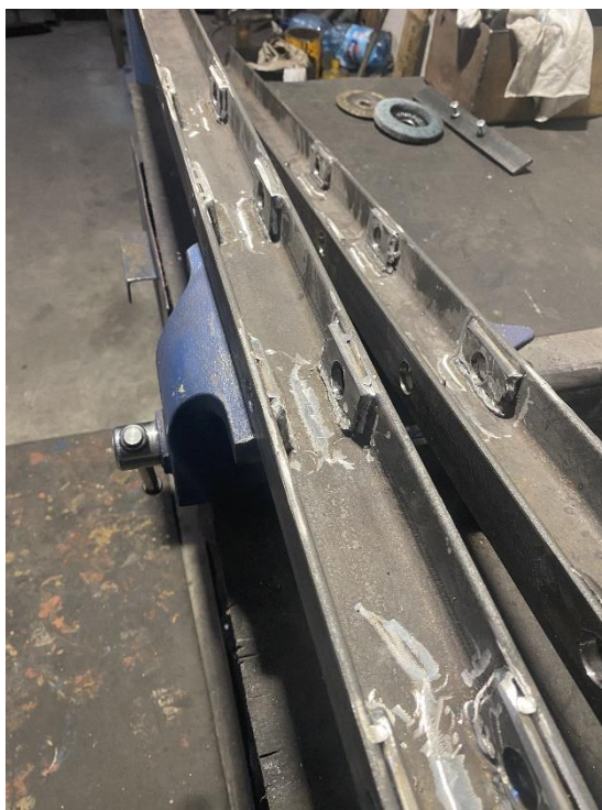
Spevnenie profilov ( Zdroj, Pohlod, D., 2023)
