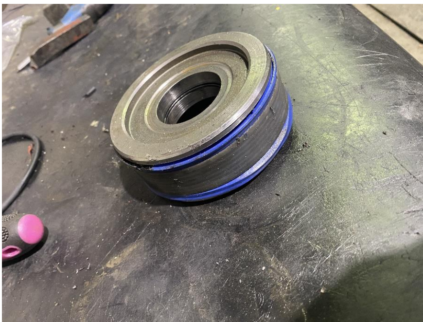
Hydraulický piest valca ( Zdroj, Pohlod, D., 2023)
