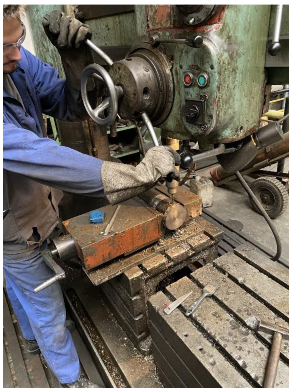
Vrtanie dier na prívod tekutiny do valca ( Zdroj, Pohlod, D., 2023)
