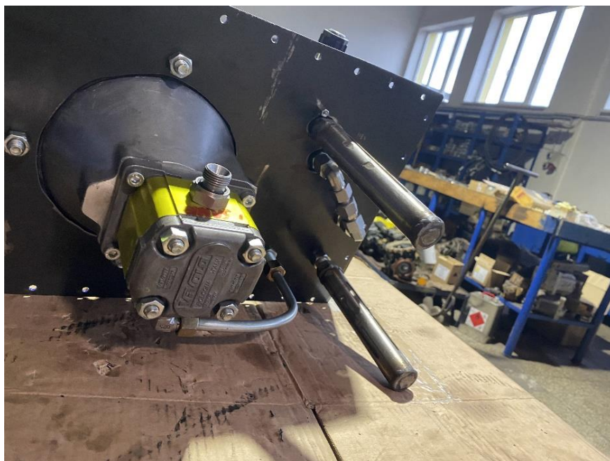
Uchytenie hydraulických komponentov na nádrž ( Zdroj, Pohlod, D., 2023)
