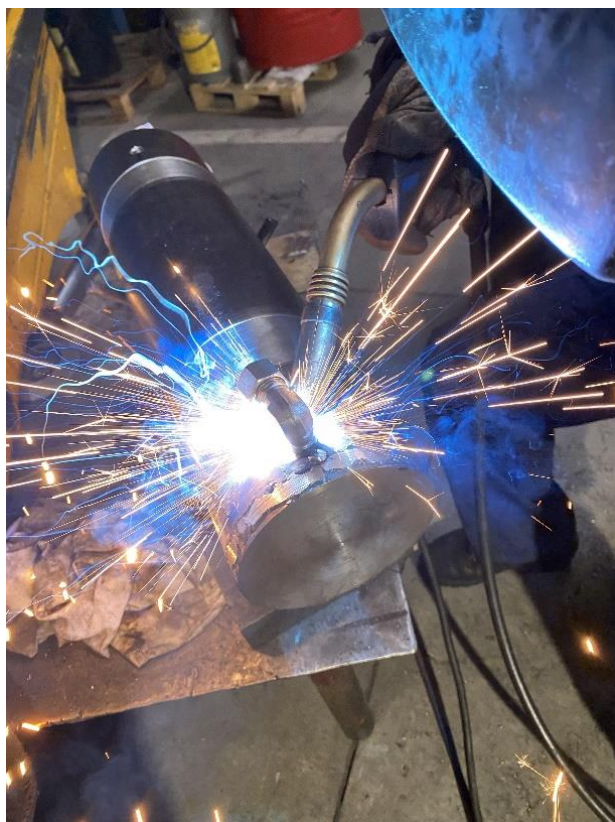
Príloha 8 – Prizváranie spojok na rúru valca ( Zdroj, Pohlod, D., 2023)
