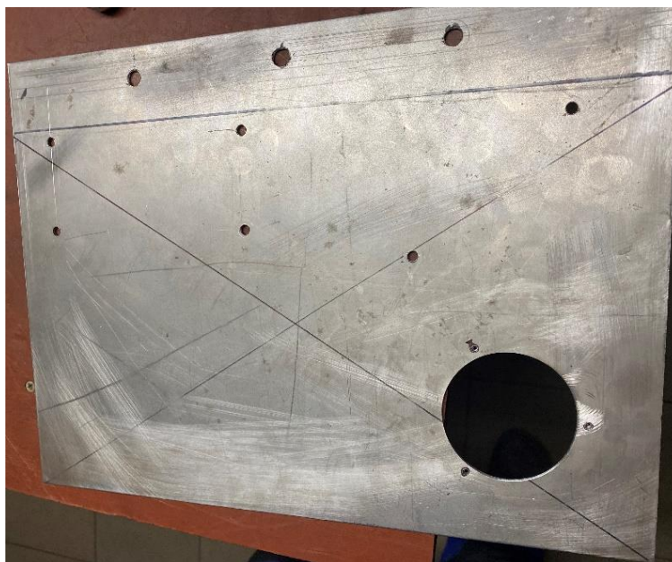
Úprava plechu na montáž elektrických súčiastok ( Zdroj, Pohlod, D., 2023)
