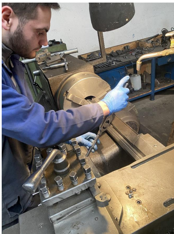
Príloha 6 – Rezanie závitú M20 do piestnice valca ( Zdroj, Pohlod, D., 2023)
