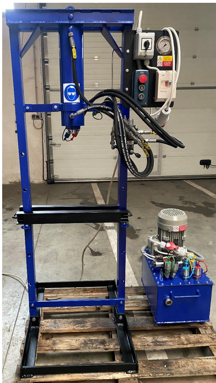
Funkčný hydraulický lis ( Zdroj, Pohlod, D., 2023)
