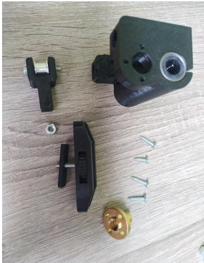
Obr. 18 Držiak osi X (pojazd osi Z)
